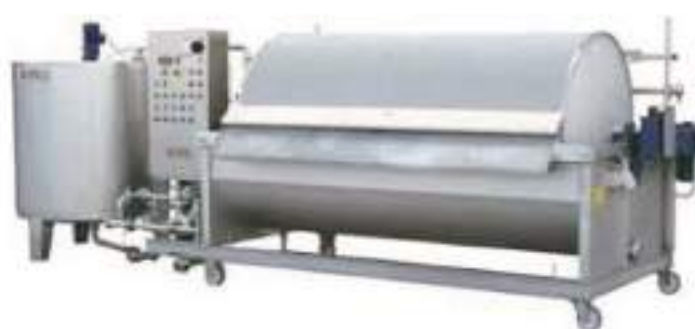
Filtration sous vide
