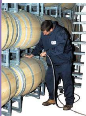
Facilité d'accès à la bonde pour le ouillage et le batonnage
