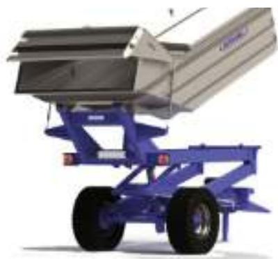
*Benne élévatrice à bec vibrant*
